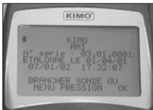
Pour accéder au menu pression, presser sur la molette ; pour accéder à un autre menu, brancher la sonde correspondante. Si celle-ci est munie du système SMART PRO, l'écran affiche le type de sonde insérée, et sa date d'étalonnage ou d'ajustage. Pour accéder au menu appuyer sur la molette. Pour revenir à la page d'accueil, débrancher la sonde ou appuyer sur "ESC" pour le menu pression.
